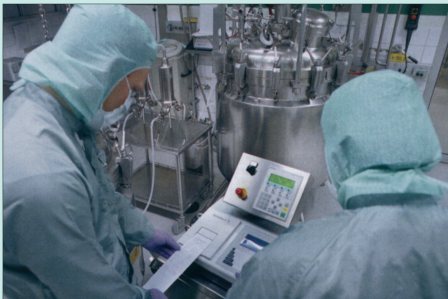
Прибор «Сарточек-4» – предназначен для контроля целостности мембранных фильтров
