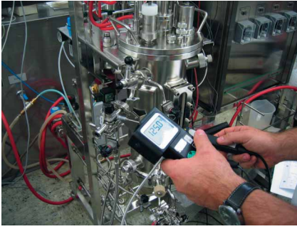
Рис. 2. Измерение температуры стерилизации обвязки при квалификации (FAT) ферментера Biostat C
