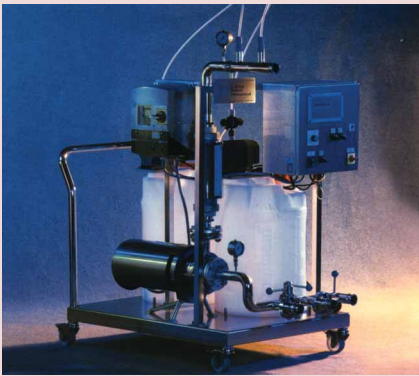
Рис.1 Ферментер фирмы Sartorius BBI Systems GmbH с автоматической мойкой и стерилизацией CIP/SIP
